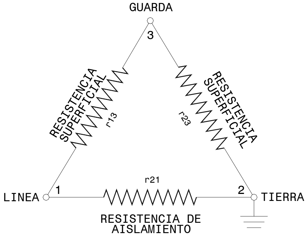
FIG. 2.4 DIAGRAMA DE RESISTENCIA DE LÍNEA - GUARDA -TIERRA
