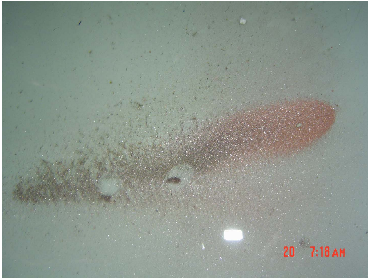
Sedimento producto de desgaste normal en el fondo después de haber drenado el aceite.
