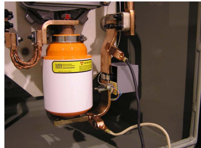
Fig. 2: Prueba de desconexión en servicio
